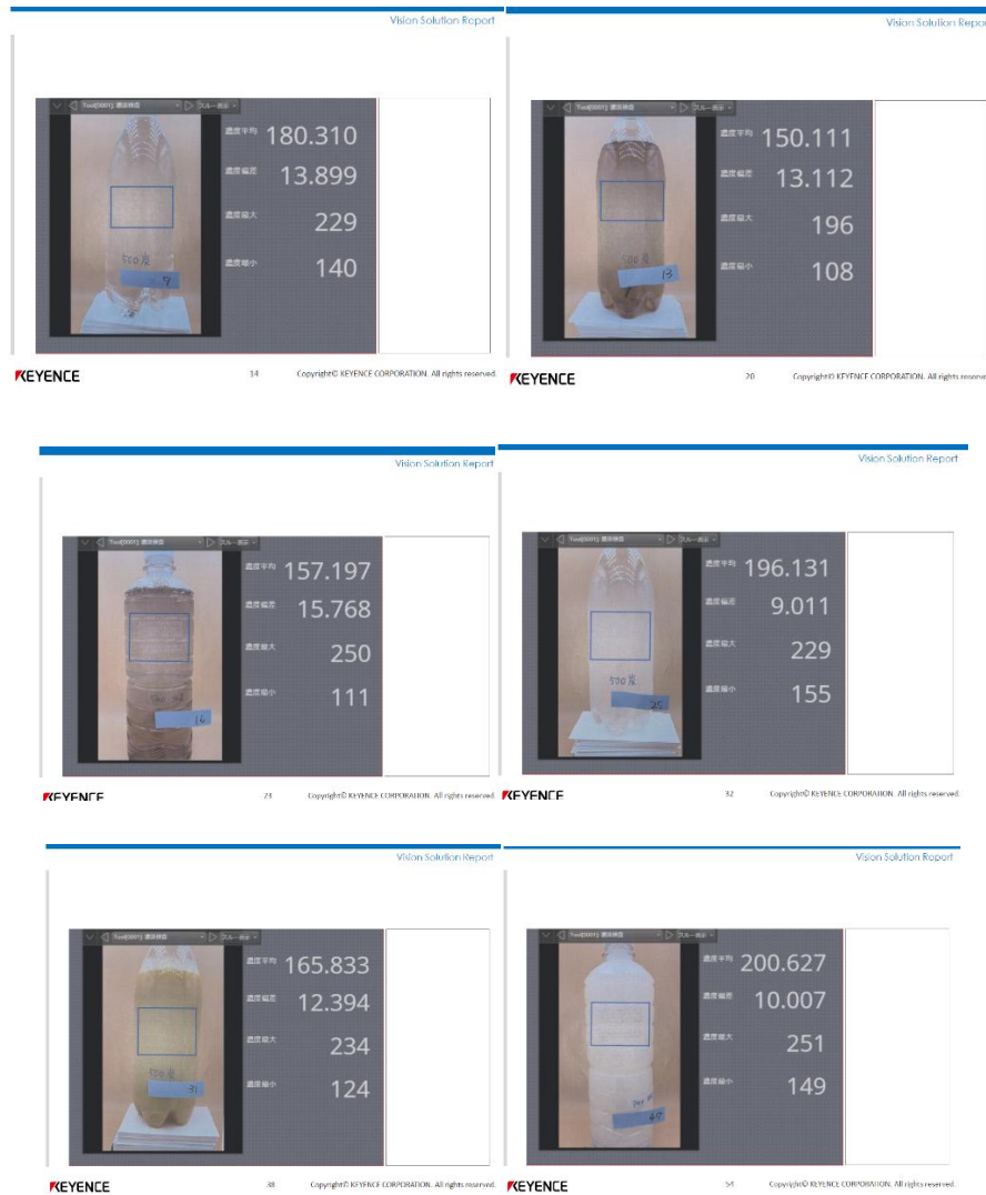
図7. ヒト視認性のカメラによる数値化の例 {下図の数値は、上記のレーザー印字品の視認性評価とは別に、試作したレーザー印字品（キーエンス社作製）を用いた*2}
