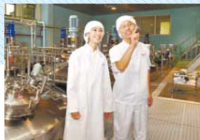
製造室を案内していただきました。ミルクに乳酸菌やビフィズ菌を入れて発酵させるタンクや、調合タンクがずらりと並んでいます
